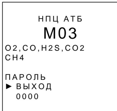
Примечание – Пароль - четырёхзначный цифровой код, который устанавливается при выпуске с предприятия-изготовителя. Код указывается в паспорте газоанализатора. Код может быть изменен пользователем в процессе эксплуатации через ИК-порт при наличии программного обеспечения работы с ИК-портом. При изменении пароля делается отметка в паспорте газоанализатора.
